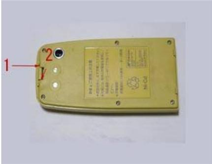
最初に蓋を開ける時は、ネジをはずし、着脱ボタンの上側、写真の①にマイナスドライバーを差し込んで開けてください。
