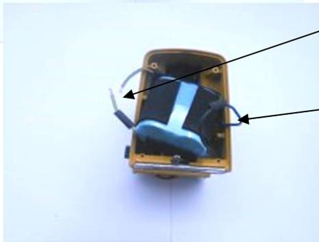
最初に通した長い電池②の黄緑線と電池③の黄緑線の被服を剥がして接続してハンダ付けして、収縮チューブを被せてライター等で収縮させてください。
