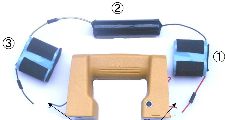
バッテリーの両側面の、脱着ボタンにドライバーを差込み取り外し、ネジ4本を取り外して蓋を開けます。
