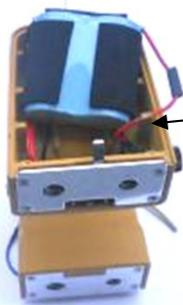
①の電池の電池の赤線の被服と、ケースの赤線の被服を剥がして、接続してハンダ付けします。
