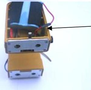
接続後、収縮チューブを被せてライター等で収縮させてください。
