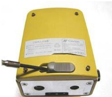
バッテリーの両側面の、脱着ボタンにドライバーを差込み取り外し、ネジ4本を取り外して蓋を開けます。
