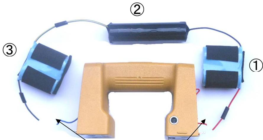
中のバッテリーを取り出して、配線をペンチで切断します。
